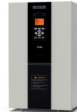
V560系列变频器基于全新的矢量控制平台，内置闭环矢量、开环矢量、V/F、力矩控制四类核心控制算法，可轻松实现各类复杂控制应用，可最多扩展3个扩展卡。变频器自带近百种警示功能，可提前预警避免故障停机。
