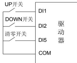
图 7-11 端子 UP/DW 接线示意图
