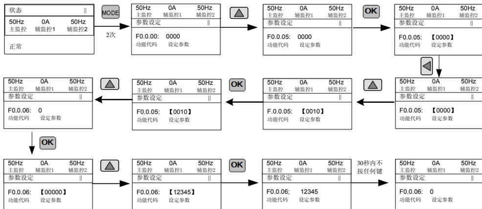
图 7-4 参数锁定操作流程
