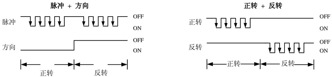
图11-7 脉冲输出形式的定义
