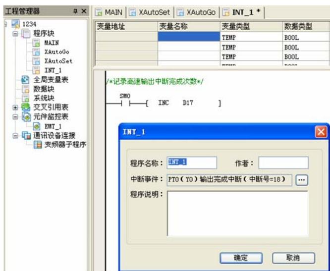
2. 在主程序 (MAIN) 中代码功能: 使系统总中断有效, 使PTO 输出完成中断的使能标志SM63 有效。使用PLS 指令。
