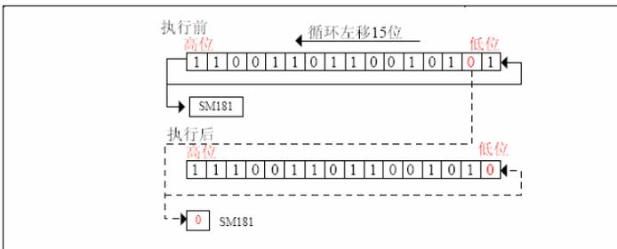
当 M0=ON 时, D0=2#1100110110010101 (52629) 循环左移 15 位, 结果赋给 D10, 位移最终位被存入进位标志位, D10=2#1110011011001010 (59082), SM181=OFF。
