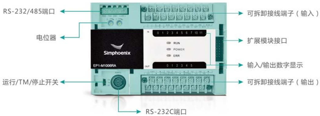
PORT0 和PORT1 为通讯口。PORT0 为RS232 电平，插座为Mini DIN8。PORT1 提供RS485 或RS232 两种电平。母线插座用于连接扩展模块。模式选择开关有ON、TM、OFF 三个档位
