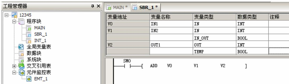
图4-11 子程序SBR\_1 的编写过程
