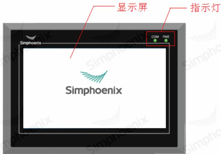
触摸屏右上角的两个指示灯分别为电源（PWR）和通讯（COM）。触摸屏通电时电源指示灯（PWR）是常亮的绿色；当成功连接上 PLC 时，通讯指示灯（COM）是常亮的绿色。
