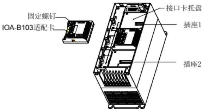
图 2 IOA-B103 适配卡的拆卸安装示意图
