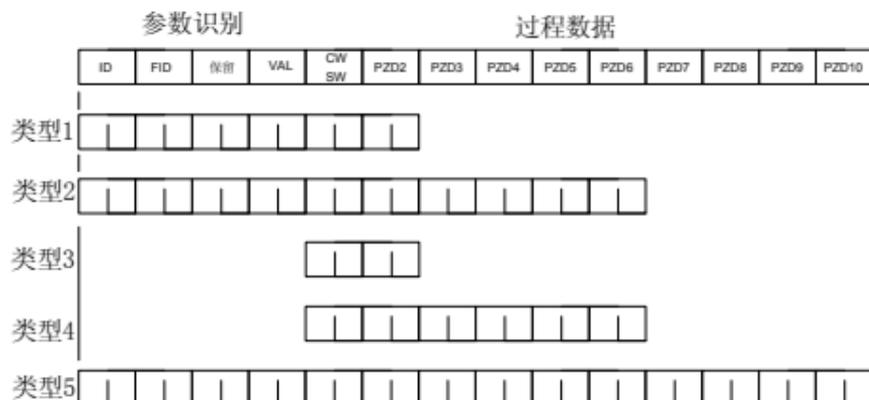
图 3 IOA-B103 通信报文 PPO 格式
