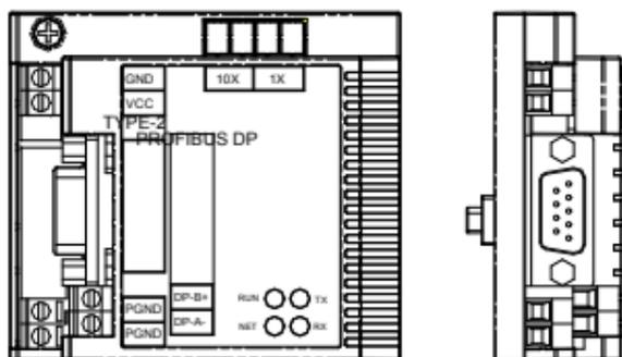
图 1 IOA-B103 适配卡外观示意图
